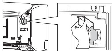
4. Включете адаптера за безжична LAN мрежа в свързващия слот на вътрешния модул по посоката, показана на фигурата.
